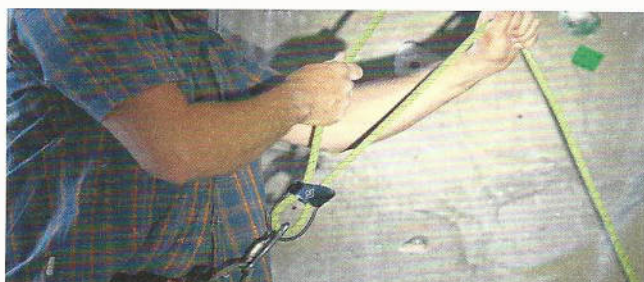
Abb. 5 Momentaufnahme von einem korrekten Sicherungsvorgang mit Smart. Die Sicherheitsfunktion ist aufgehoben.
